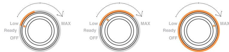
속도조절 스위치를 오른쪽으로 돌려 Low에 위치하면 전면부에 불이 2칸 들어오고, 최소 속력으로 작동됩니다. 속도조절 스위치를 오른쪽(시계방향)으로 돌리면 전면부의 LED가 1칸씩 증가하며(총 6칸) 블렌더 작동 속도가 높아집니다. 반대로 왼쪽으로 돌리면 속도가 줄어듭니다. 속도조절 스위치를 MAX에 위치하면 전면부 LED가 모두 들어오게 되며, 이때 최고 속도로 작동됩니다.
